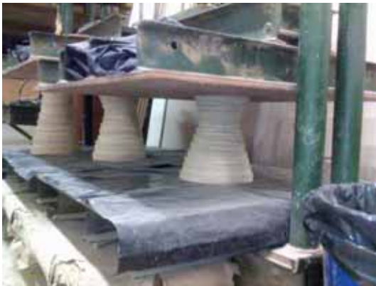
Figura 88. Prensagem dos laminados da banqueta Carretel [Foto do Autor]
