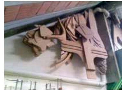
Figura 61. Gabaritos de algumas peças. Nota-se o primeiro da direita para a esquerda, o gabarito da Chaise Baleia [Foto do Autor]
